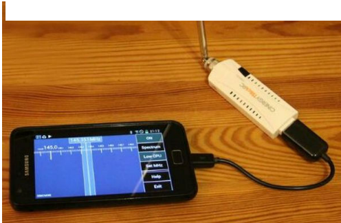
SDR ontvanger. Android smartphone met Conrad DVB-T-USB stick en SDR Touch App van Martin Marinov.
